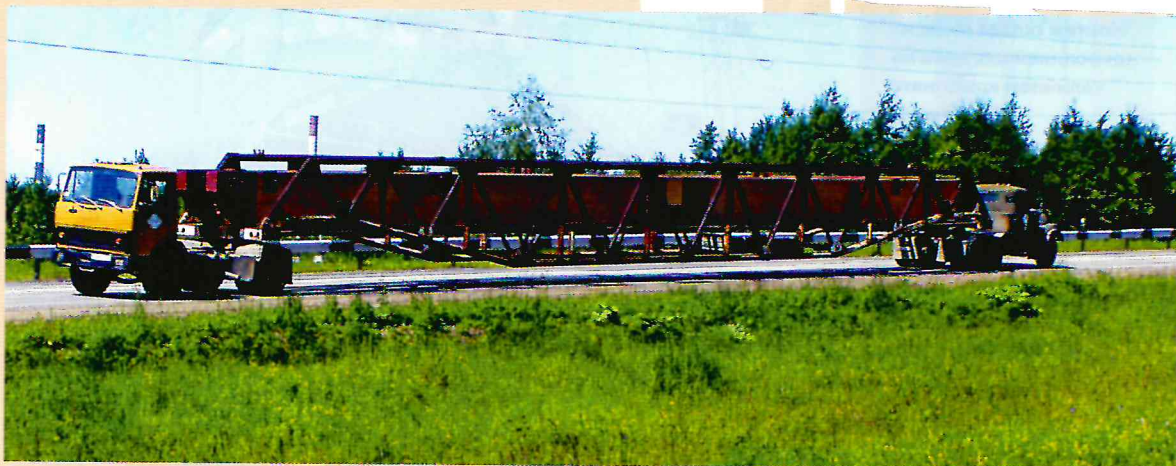
Арковоз для перевозки прямолинейных элементов арки
